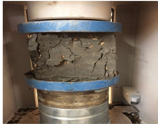
شكل 7 : اختبار مقاومة الضغط
